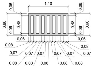
Vista superior da tampa em concreto pré-fabricado das bocas de lobo com espaçamento entre vãos de 7 cm e dimensão da abertura de 8 x 48cm.
