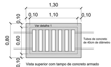
Vista superior com tampo de concreto armado
